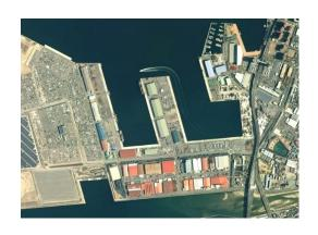
汐見埠頭は、上屋、倉庫等の施設が充実した、一大外 貿埠頭として機能しています。この埠頭は、鋼材、木 製品等の貨物を取り扱っています。特にこの埠頭の 先端にある5号岸壁は、重量物専用岸壁として整備さ れており、水深12m岸壁延長720mで30,000 DWT の大型船舶が3隻同時に係留することができま す。また、耐震強化岸壁となっているため、地震などの 災害時には、緊急物資の供給基地となります。さらに この埠頭の奥の沖合には大阪湾フェニックス計画に よる埋立てが行われています。
