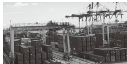
RTG(ラバータイヤ式ガントリークレーン)視察
