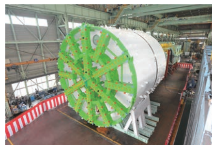
シールド掘進機
