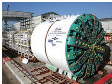
2011年 シアトル向け世界最大級土圧シールド掘進機
