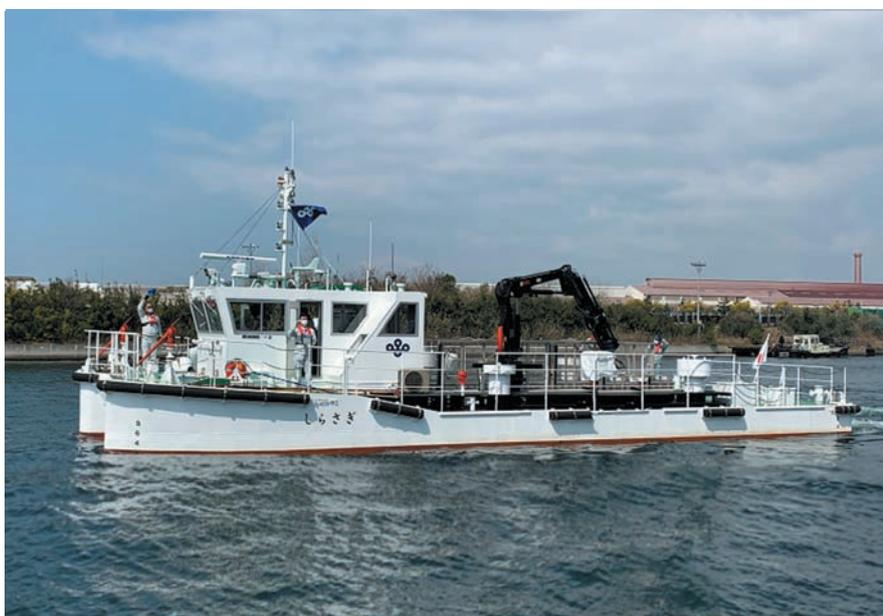
本船は船体の中央にゴミを回収する装置があり、海上に浮かぶ漂流ゴミを収集することができる清掃船で、堺泉北港を中心に活躍してくれます。
